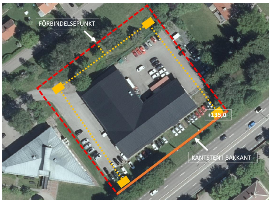
Figur 7. Principiell utformning för hantering av dagvatten. Orangeat streck visar föreslagen placering av kantsten, om denna inte önskas kan höjdsättningen av marken göras så att alla ytor lutar mot rännstensbrunnar som placeras i lågpunkt. Gula rutor visar schablonmässiga förslag för brunnars placering.
