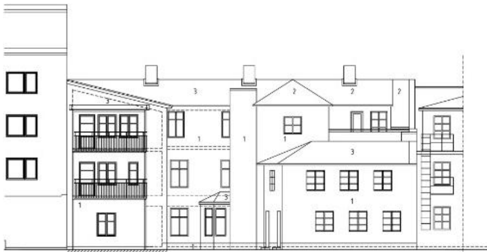
Fasad mot gården. 1- puts, 2- tegelpannor, 3- slätplåt, 4- granit. Det högre huset till vänster i bild ligger inom angränsande fastighet. Ritning: Mondo Arkitekter.
