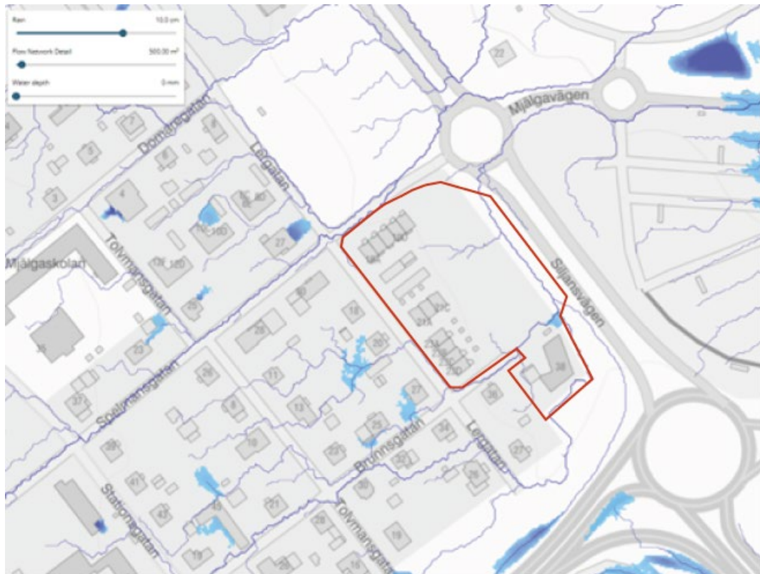
Figuren visar vattendjup och huvudsakliga rinnvägar vid ett skyfall. Utdrag Scalgo. Planområdet ungefärligt inramat med röd linje.
