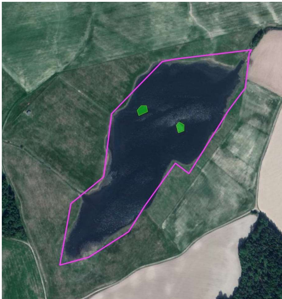
Figur 11. Åtgärdsytor är markerade med grönt. De föreslagna åtgärderna omfattar erosionsskydd på den befintliga ön (höger i bild) samt fler fågelöar (ett förslag för en fastmarksö är inritad i bilden, ett alternativ är 2-3 stycken flytöar).
