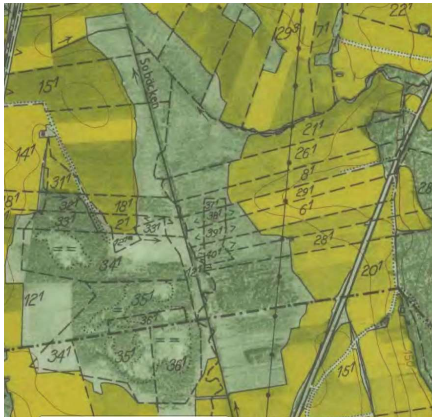
Figur 51. Karta från 1950-talet där man ser att fastighetsgränsen kring dikesfåran meandrar. Den meandrande gränsen indikerar att Sobäcke en gång i tiden hade en meandrande sträckning här.
