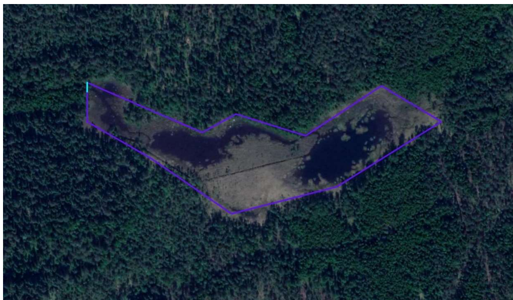
Figur 58. Den föreslagna åtgärden, igentäppning av det läckande dämnet, är markerat med en ljusblå linje.
