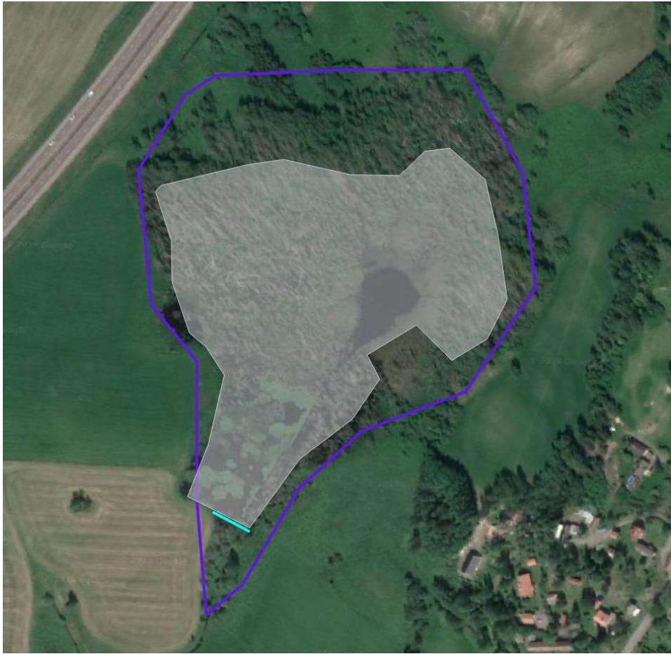
Figur 68. Den föreslagna åtgärden består av att anlägga ett permanent dämme vid utloppet av sjön som är markerad med ett blått streck. Den gråa ytan är den ungefärliga vattenytan som skulle kunna skapas mer permanent (vattenytan finns idag på grund av ett bäverdämme på samma plats som det föreslagna dämmet).
