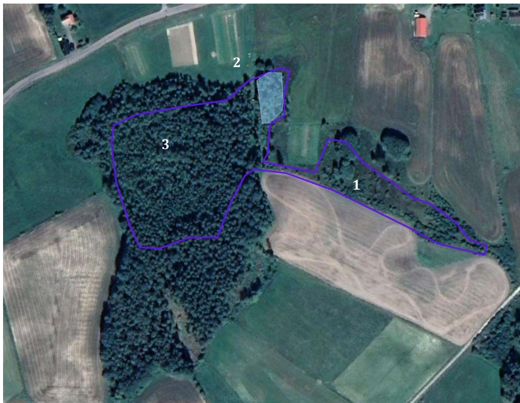
Figur 63. Åtgärdsytan, som består av grävning av en damm, är markerad med en grå yta. 1=östra våtmarksområdet, 2=befintlig liten damm, 3=våtmarksområdet Träsket.
