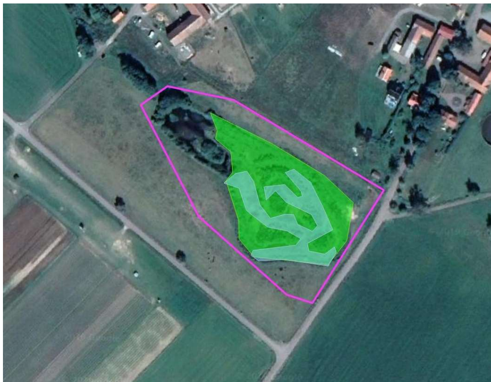
Figur 21. Åtgärder är markerat med grönt, den gråa ytan är förslag på ungefärlig grävning för djuphåla. I övrigt föreslås röjning av sly samt gärna bete eller årlig slåtter.
