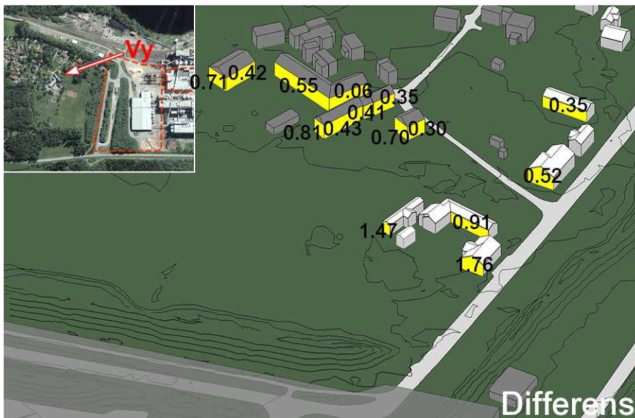
Figur 5.16. Skillnad (%-enheter) i vertikal dagsljusfaktor, VDF, mellan nuläget och planförslaget för bostadshusen norr om planområdet.
