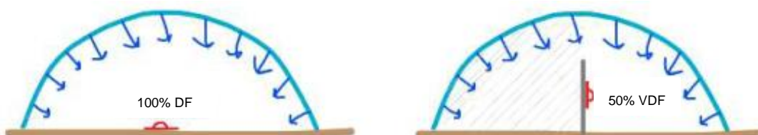
Figur 5.13. Illustration som visar maximal dagsljusfaktor (DF) till vänster samt maximal vertikal dagsljusfaktor (VDF) till höger. Figur från ljus- och skuggstudien.
