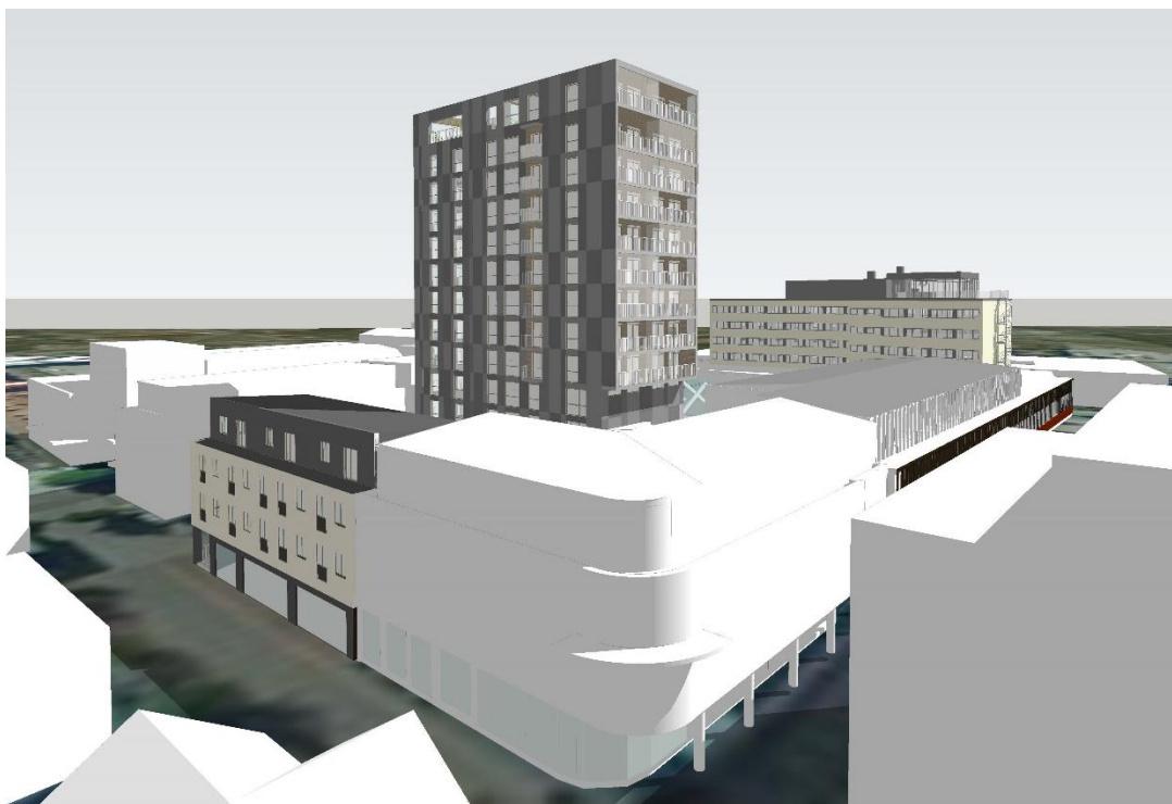
Figur 3. Kvarteret Balder sett från norr, korsningen Målaregatan-Sveagatan, med förslag till nya byggnader: punkthus samt lamellhus mot Målaregatan inom Balder 9 och en påbyggnad av befintlig kontorsbyggnad mot Sveagatan inom Balder 8 samt en takterass ovanpå Hotell Brage. Källa: Gestaltningsförklaring kvarteret Balder, RK Arkitektur AB.
